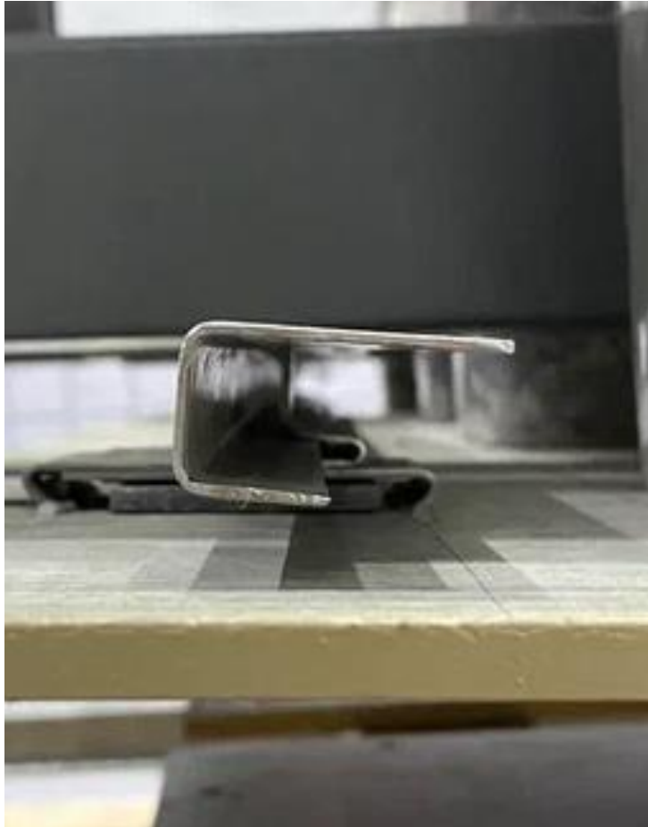
Рис. 27. Положение горизонтального направляющего профиля и кляммер при нагрузке, предшествующей разрушению
